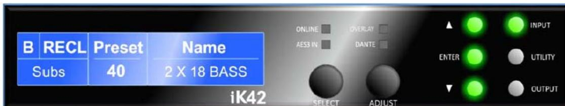
7. これを繰り返します。ロータリーエンコーダを回して XE300 を選択、“Enter”を 2 回押す、プリセットの設定が完了したら、もう 1 度“Input”を押して次は C という流れです。さらに D の設定まで完了したら、“UTILITY”を押してホーム画面に戻ります。
