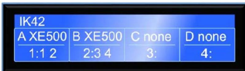
上記の画面では、DSP A と DSP B にどちらも XE500 のプリセットを呼び出した状態です。入力 1 が出力 1 と 2 に、入力 2 が出力 3 と 4 にルーティングされ、入力 3 と 4 は何にも使われていないという状態を表現しています。これでアンプは使用できるようになったわけです。
