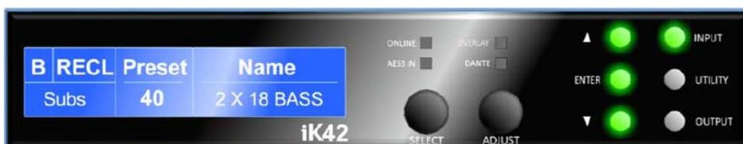
7. そうすると画面には入力 B に対してのプリセットを設定するページが表示されます。またロータリーエンコーダを回して XE500 を選択し、“Enter”を押します。
