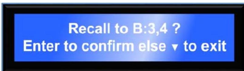
8. “Enter”を押しプリセットロードが完了します。次に“UTILITY”を押して元の画面に戻ってください。
