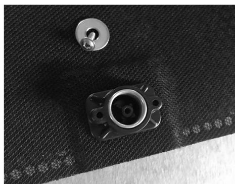
3. +ネジとドーナツ型のワッシャを取り外すと、図のようにスプリングが出てきますので取り出します。
