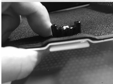
指でバッジのX字の部分を押し込むことで、図のようにグリルバッジがずれ、グリルとの間に隙間をつくれます。
