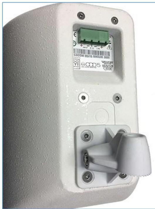
下記図のようにスピーカー側のブラケットと壁側のブラケットをはめ込んで、六角レンチでブラケットを接続し、固定します。この時、パンやチルトが希望通りの角度になるようにブラケットの噛み合わせ部分を調整したうえで六角ネジを締め込みます。
