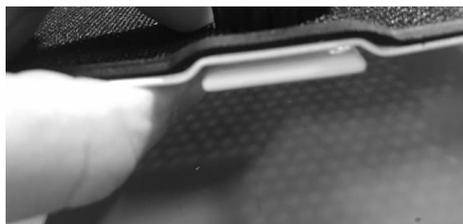
グリルとバッジの隙間にマイナスドライバーなどを入れてロゴバッジを少し浮かせて、ロゴバッジを90°回転させます。
