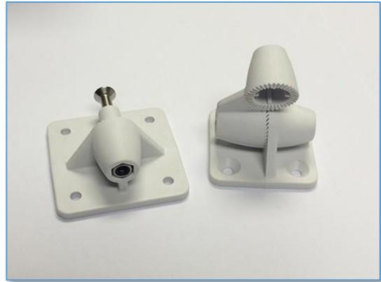
水平および、垂直の角度設定は4mm六角レンチを使用し、中心パーツの六角ネジを緩めて角度を調整します。
