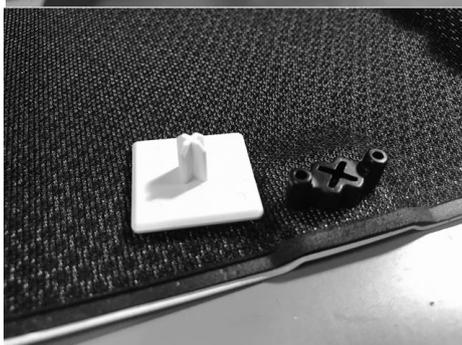
指やマイナスドライバーなどを使って隙間を広げることで、図のようにグリルバッジが外れます。適切に回転させてバッジを逆の手順で取り付けなおします。もしくは新しいバッジを取り付けます。
