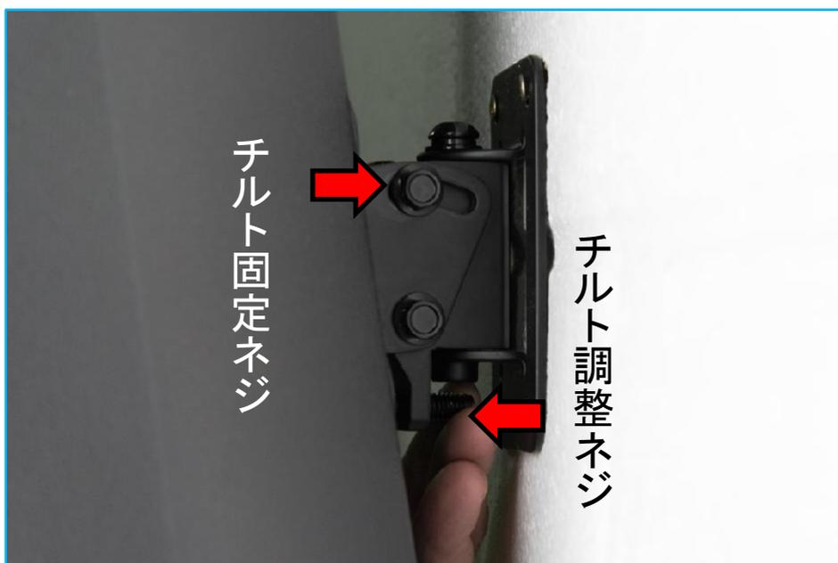
チルト調整はチルト固定ネジを軽く緩め、チルト調整ネジを回すことによってスピーカーチルトを調整します。チルトが決まったら、チルト固定ネジを締めこんでチルトを固定します。
