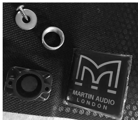
4. グリルバッジが図のように取り外せます。交換するバッジを逆の口順で取り付けます。
