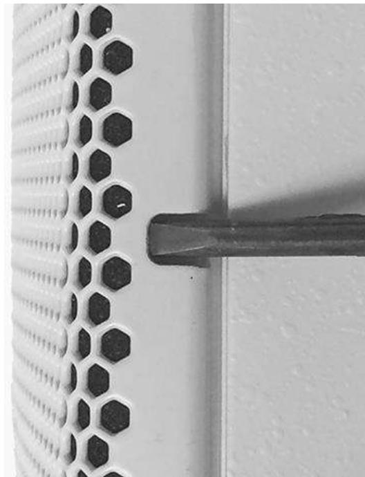
2. 差し込み口に工具を図のように差し込みます。(差し込み口が3点ある場合は、真ん中以外に差し込みます)
